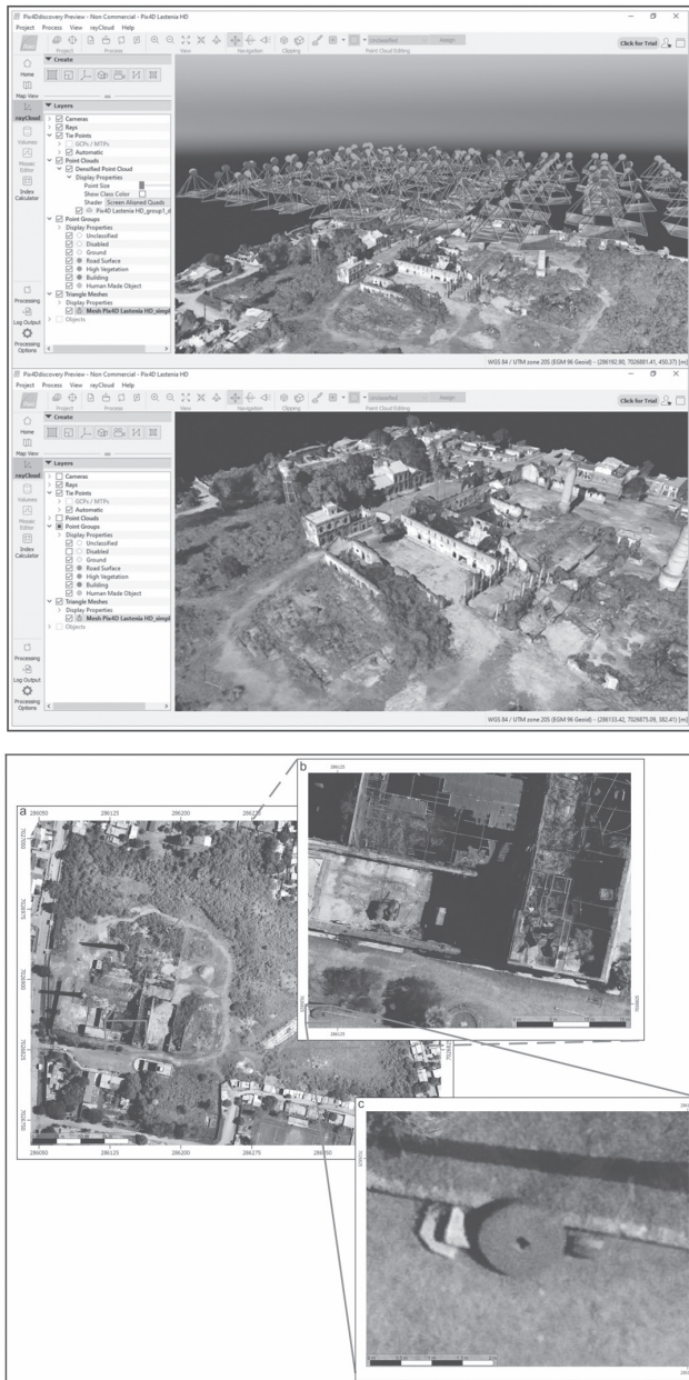
Figura 2. Diferentes instancias del procesamiento de imágenes de drones. Arriba: modelado tridimensional del sitio mediante el empleo del software Pix4D . Abajo: comparación de escalas, imágenes procesadas mediante el empleo de QGIS3 .
